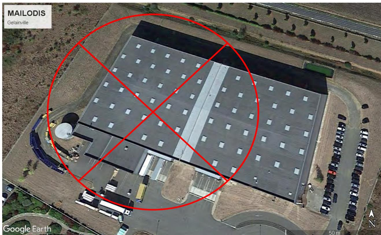
La toiture est constituée de bac acier recouverts d'une étanchéité bitumeuse, les distances de séparations sont nulles. Les parois sont constituées de béton et de poutre en béton précontraint (béton armée). Les distances de séparations seront calculées sur la longueur maximale des conducteurs de descente.
