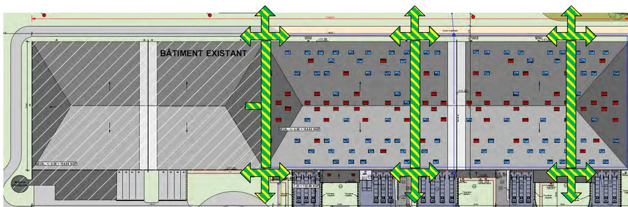
Effets directs : emplacement des conducteurs de toitures et des prises de Terre de type A
