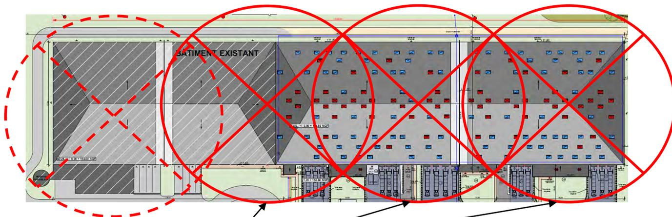
Effets directs : protection par 3 PDA (sur mât de 5m), avec une avance à l'amorçage de 60µs le rayon de protection (pour une ICPE) est de 64,2m.
